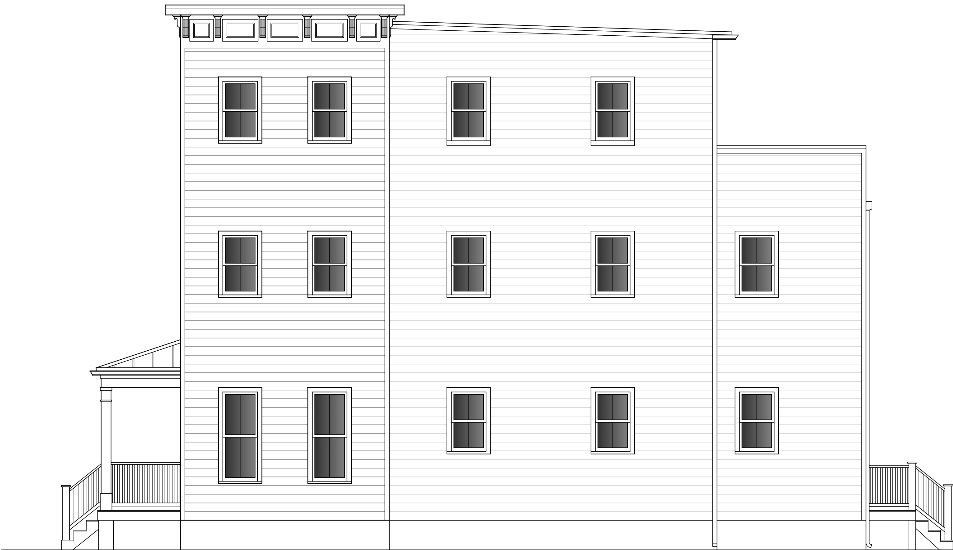
01 | RIGHT SIDE (BURTON ST.) ELEVATION 1/4" = 1'
