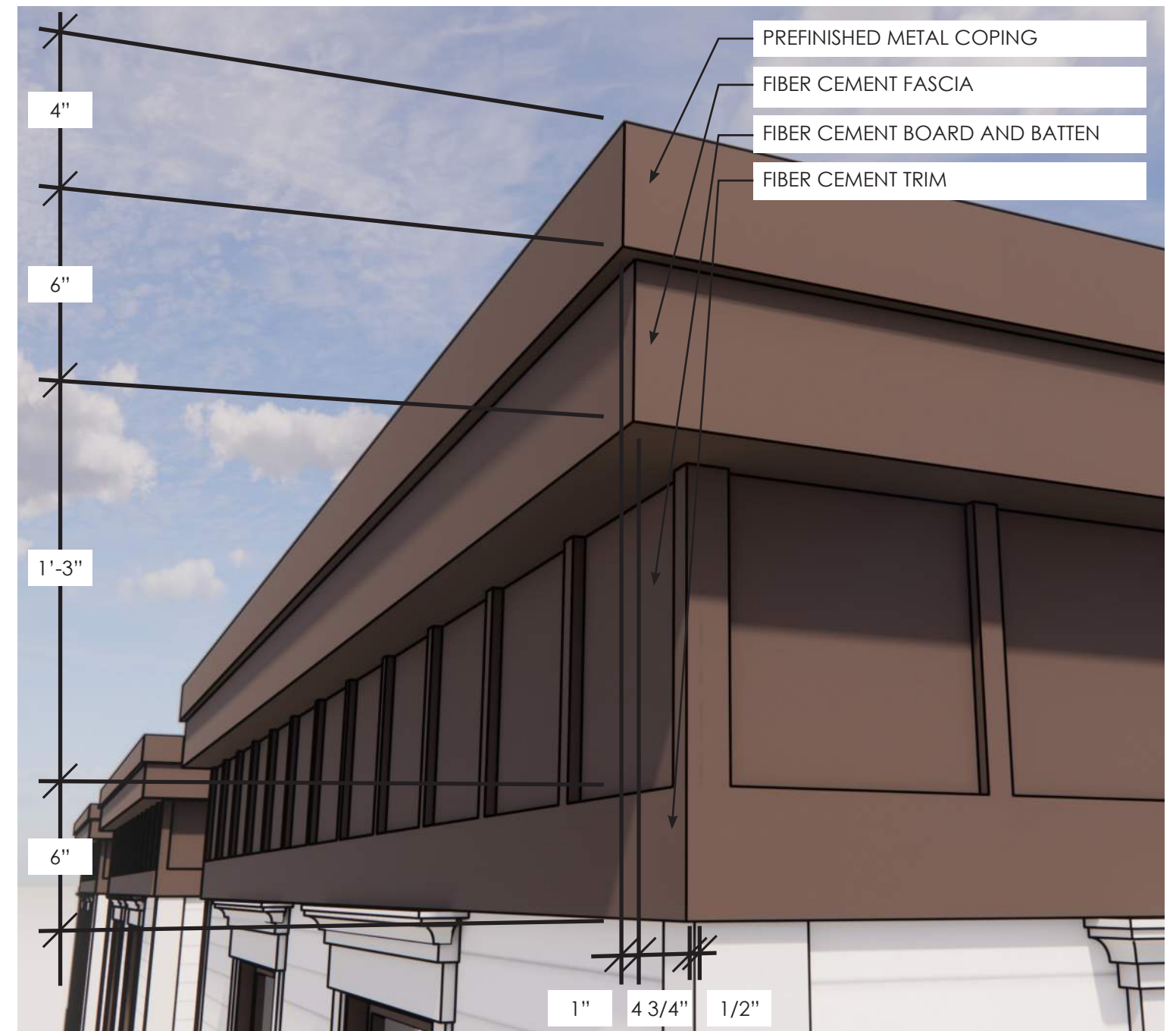
2 CORNICE - DETAIL SCALE: NTS
