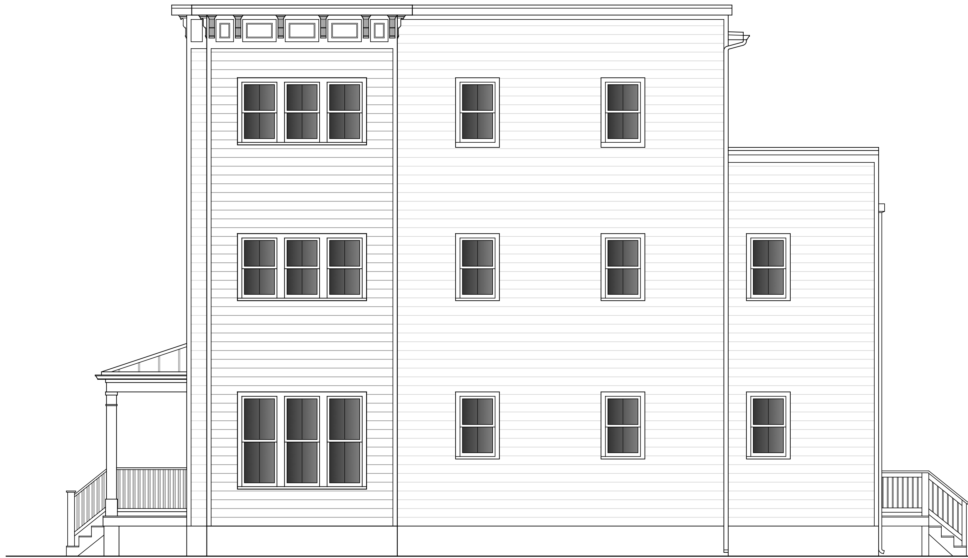
01 | RIGHT SIDE (BURTON ST.) ELEVATION 1/4" = 1'
